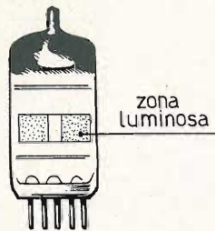
Fig. 1 - La zona luminosa dell'indicatore catodico EAM86 occupa una fascia orizzontale, di forma rettangolare, sul bulbo di vetro del tubo. L'effetto ottico si manifesta attraverso una separazione o un avvicinamento delle due fasce.
